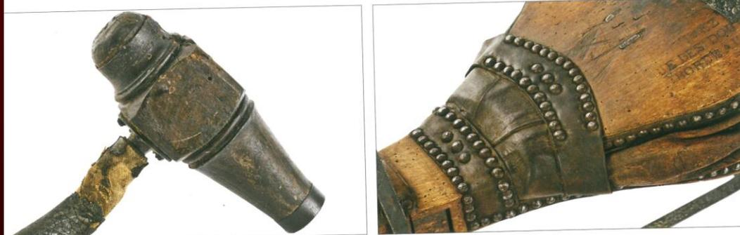
*Le soufflet à soutirage est employé pour le soutirage des vins, par l'esquive. À l'aide du robinet et des cuirs de soutirage, ou pour soutirer par les bondes. Il permet le déplacement du vin par la compression de l'air, sans que les lies et les dépôts ne soient troublés.*
